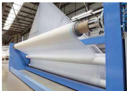
Máquinas de última geração fabricam materiais com larguras de até 7,6 metros sem costuras
